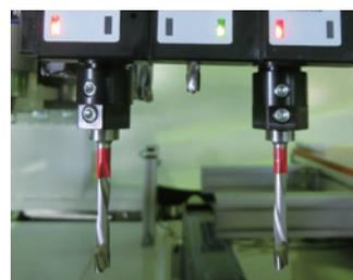
ボーリングマシンの穴あけ加工中に、パネルに異物が混入していたり刃物が切れなくなってくると、加工した穴の深さが指定どおりになりません。低速で加工する方法もありますが、それでは加工スピードが遅くなります。
